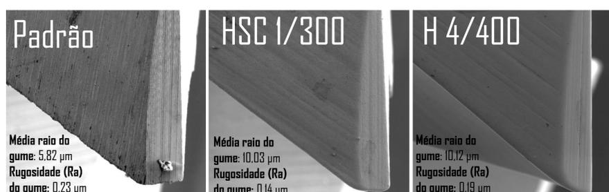
Fig. 3 Flanco nas três condições de gume de corte com ampliação de 500x, MEV
